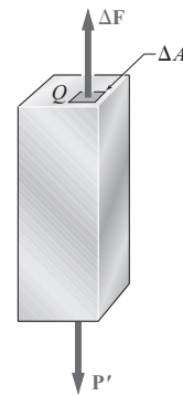
Fig. 1.9 Pequena área \Delta A , em um ponto arbitrário de uma seção transversal, comporta \Delta F na sua barra axial.
